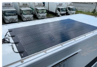
配送車両の車体上部に薄型太陽光パネルを搭載
