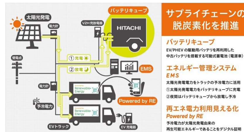
蓄電池（バッテリーキューブ）や電力測定装置（EMS）模式図
