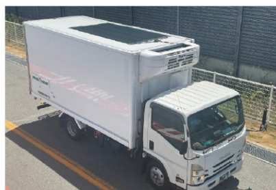
配送車両の車体上部に薄型太陽光パネルを搭載
